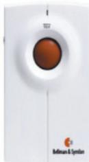
Es un transmisor de radio que reconoce las señales de llamada de un sistema telefónico analógico a través de un conector que se inserta en la toma del teléfono. De esta forma, cuando se realice la llamada se activarán los diferentes receptores disponibles.
