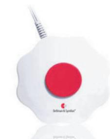
Se coloca debajo de la almohada y avisa de las diversas llamadas que se produzcan mientras el usuario descansa. Este dispositivo puede conectarse al cargador del buscapersonas (en este caso, para que funcione el vibrador de almohada, el buscapersonas debe estar colocado en dicho cargador), o a un receptor flash Bellman Visit 868.
