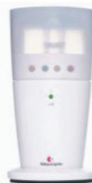
Es un receptor de señales radio para interiores que atrae la atención del usuario con un destello intermitente en forma de señal luminosa. En las pruebas practicadas con usuarios, el flash se activaba a través de las señales de radio procedentes de los transmisores del sistema Bellman Visit 868.
